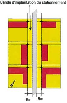
Schéma n°3 indiquant la bande d'implantation des places de stationnement le long de la voie
