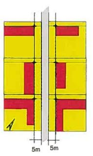
Schéma n°1 indiquant les différentes possibilités d'implantation de la construction, suivant un point d'ancrage établi en retrait de 5m par rapport à la voie.
